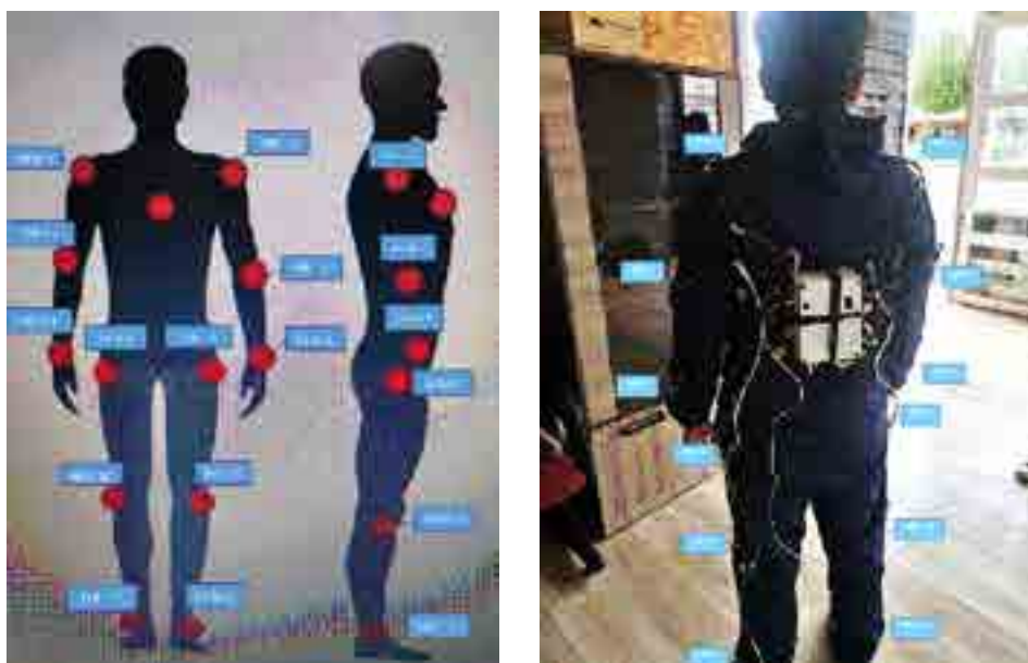
Figura 2. Traje con los sensores inalámbricos y la central de control previa la ejecución del gesto deportivo.
