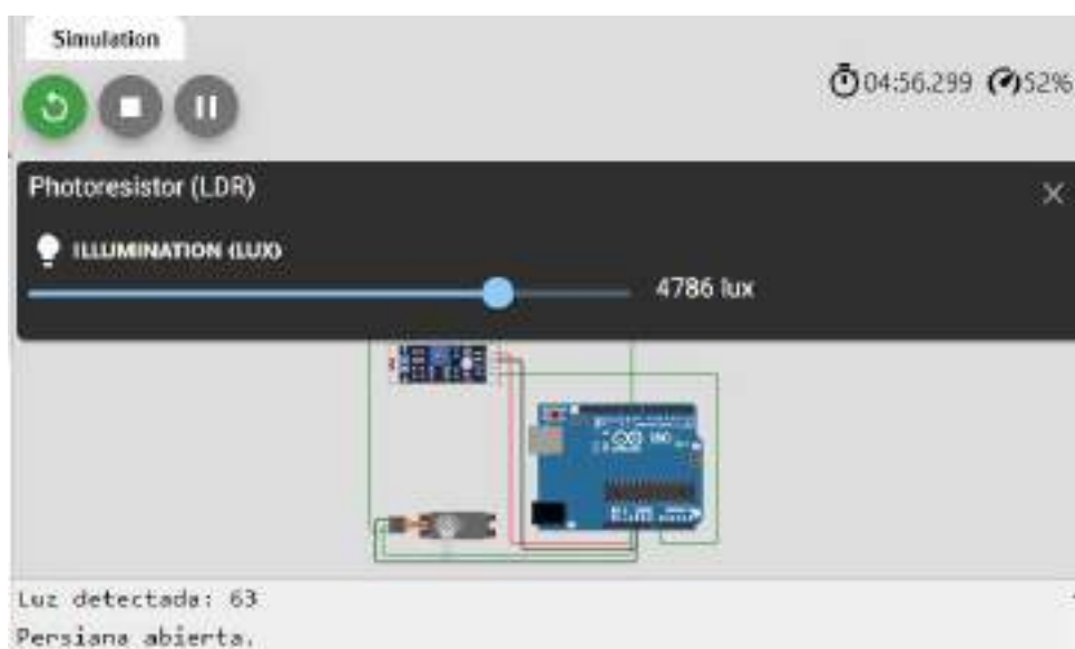
Figura 14: simulación en la cual se ajustado la luz del sensor y la persiana está abierta
