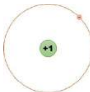
Figura 9: Equivalente estructural del átomo de cobre.
