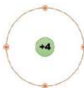
Figura 11: Equivalente estructural del átomo de silicio
