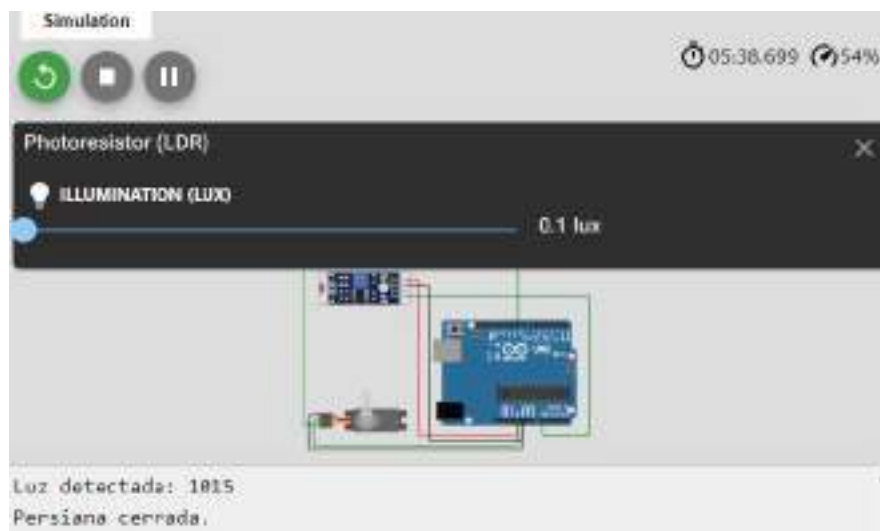
Figura 15: simulación en la cual se ajustado la luz del sensor cambiando los valores y se cierra la persiana
