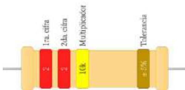
Figura 5: Esquema de código de colores en una resistencia de 4 bandas, a 220 k \Omega al \pm 5\% de tolerancia.
