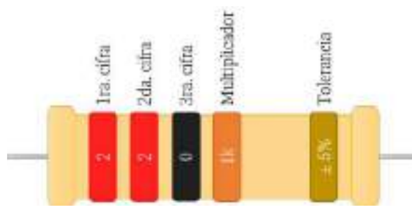
Figura 6: Esquema de código de colores en una resistencia de 5 bandas, a 220 k \Omega al \pm 5\% de tolerancia.
