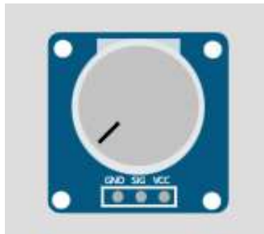
Figura 10: potenciómetro que simula el sensor de humedad
